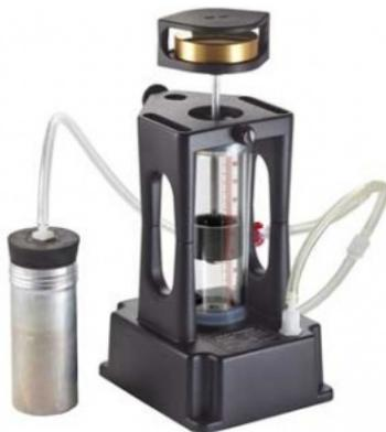
Appareil d'étude de la loi des gaz parfaits et du principe du moteur thermique
